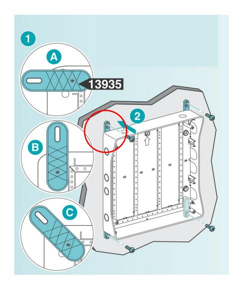
1 – Le coffret est livré avec des pattes de fixation externes. Monter les pattes sur le coffret selon vos préférences (montage horizontal (A), vertical (B) ou incliné (C)). Plaquer le coffret au mur et faire les marques correspondantes aux points de fixation. Enlever le coffret. Percer les trous diamètre 6 et placer les chevilles. Replacer le coffret et visser les vis dans les chevilles.
