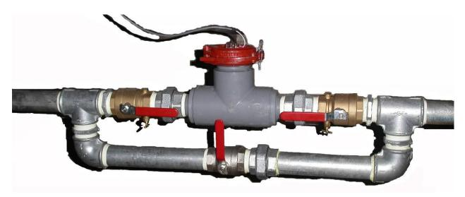
L'appareil peut être installé sur des tuyaux en métal ou en PVC et CPVC en utilisant les bons adaptateurs et en s'assurant de l'étanchéité des raccords. Toutefois, des micro courants électriques peuvent circuler aux bornes de la chambre (quelques centimètres) et favoriser la corrosion accélérée des raccords métalliques. Il est donc préférable de réaliser le montage du « bypass » en C-PVC ou avec des raccords dia électriques.
